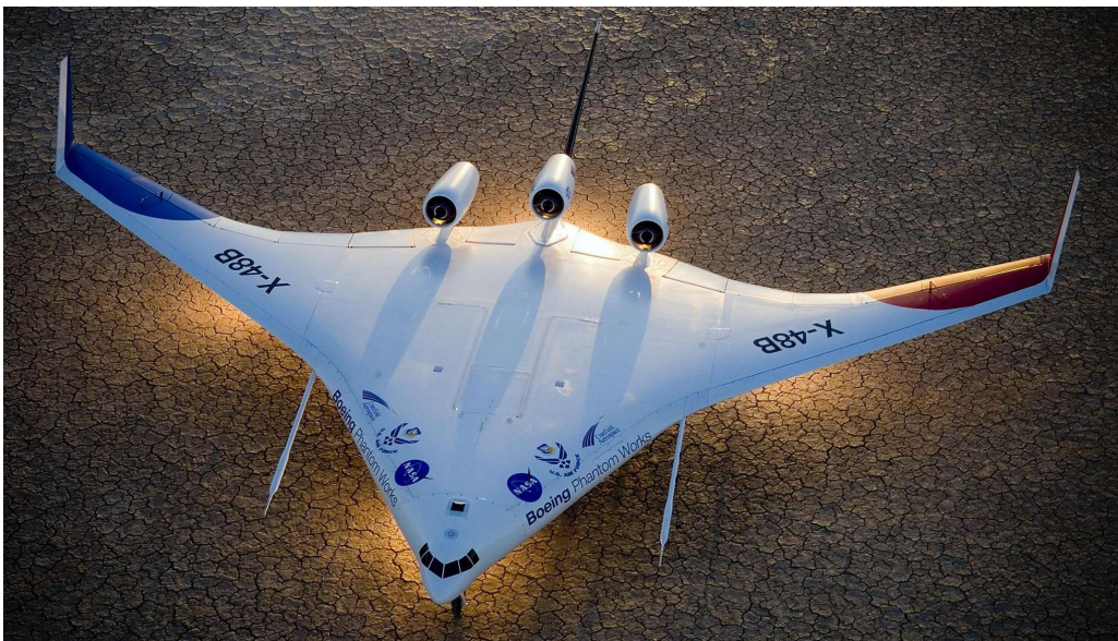
Rysunek 3. Samolot w konfiguracji blended wing body – X-48B. Źródło: [6]
