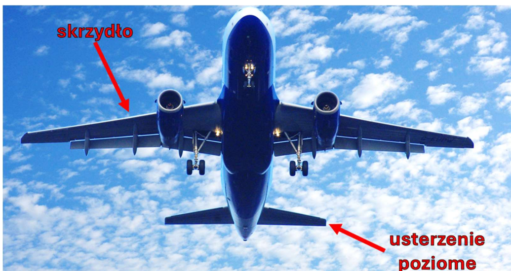
Rysunek 2. Samolot w konfiguracji konwencjonalnej – Airbus czy Boeing? Źródło: opracowanie własne na podstawie [5].
