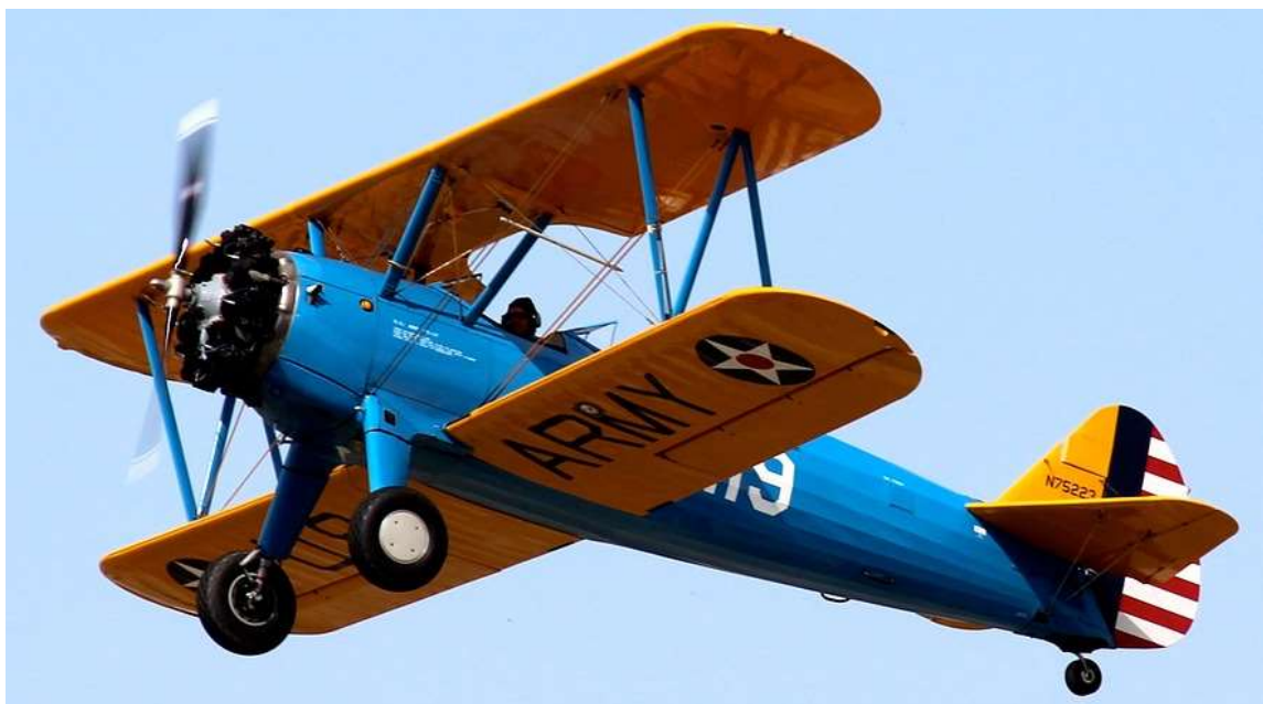
Rysunek 5. Dwupłat – samolot z dwoma skrzydłami jedno nad drugim. Źródło: [8].
