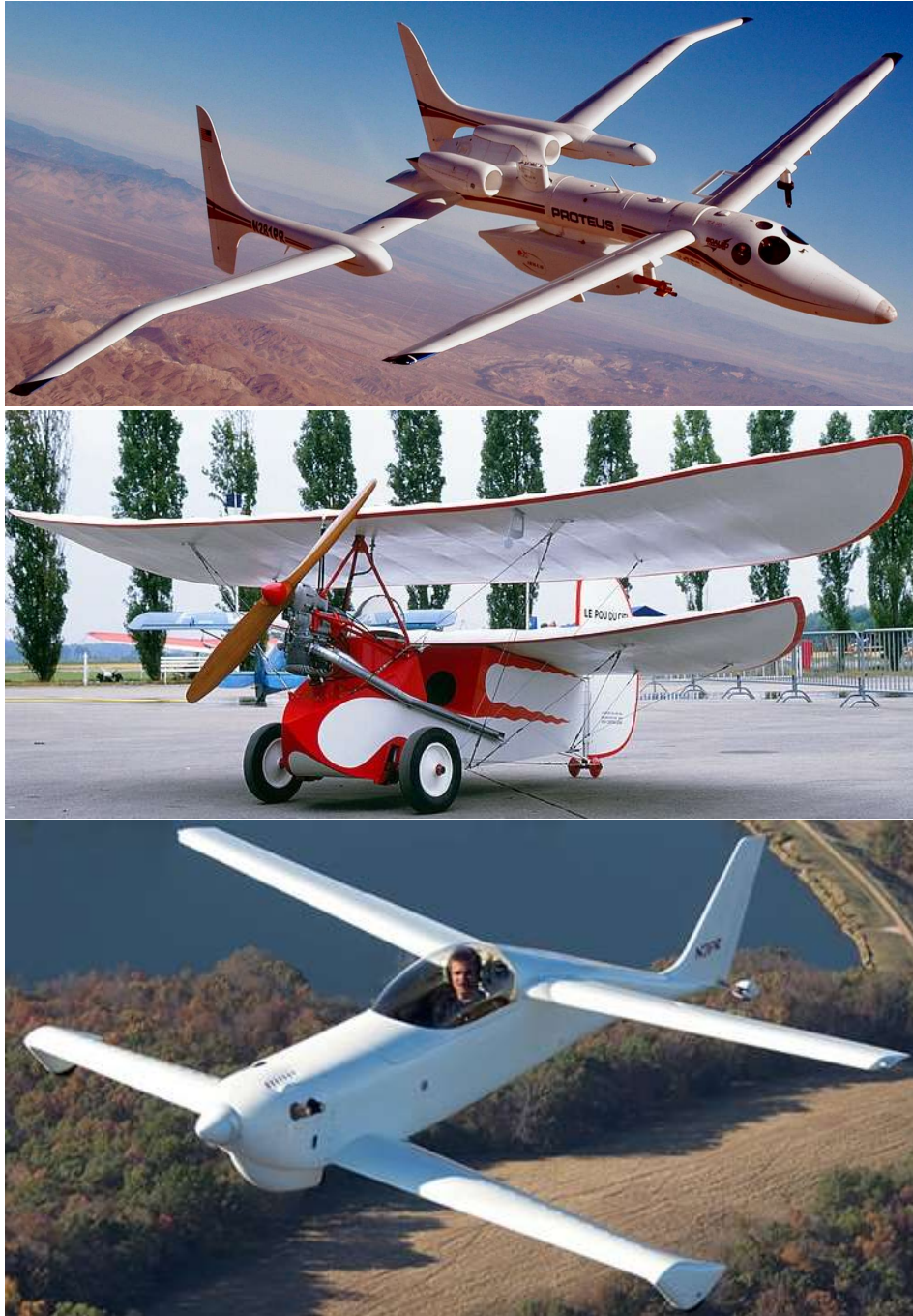
Rysunek 6. Przykładowe samoloty w konfiguracji tandem wing. Źródło: [9-11].
