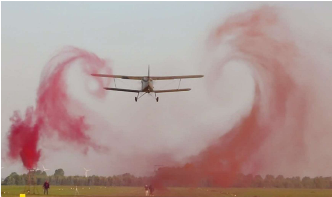
Rysunek 7. Przykład wizualizacji wirów za samolotem z wykorzystaniem dymu. Źródło: [12].
